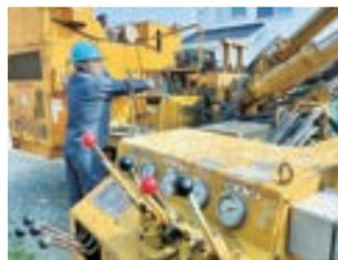
ボーリングマシンという穴を掘る大型機械で約30m掘り進めます。地下の水があるところへ届くと水が出てきますが、水が出ない場合はもっと深く掘ります。
